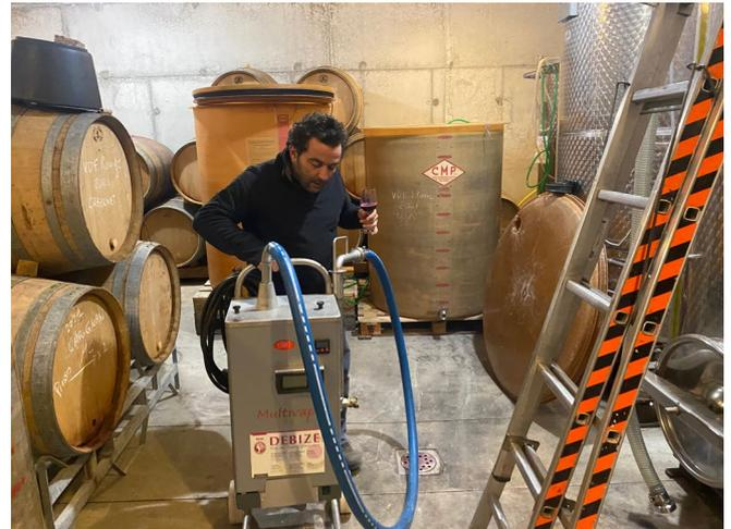
(写真②) 効果抜群の100℃の蒸気を噴射できる樽洗浄機
