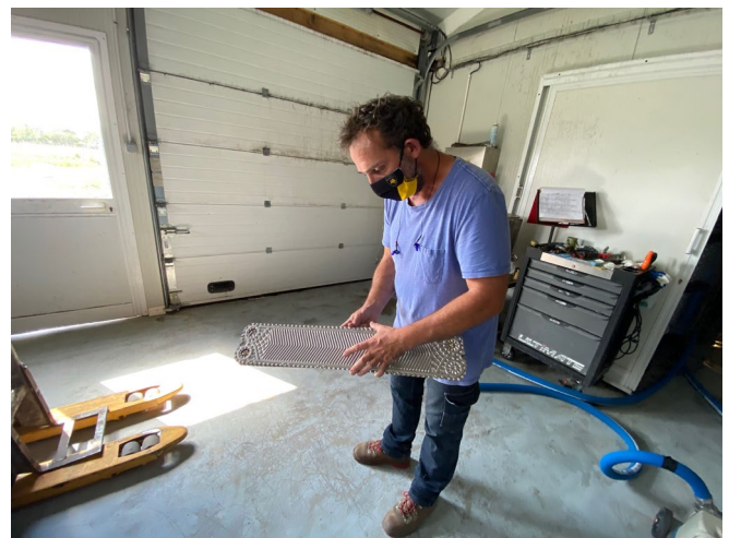
(写真②) ビール廃棄の原因となったステンレス製の板
