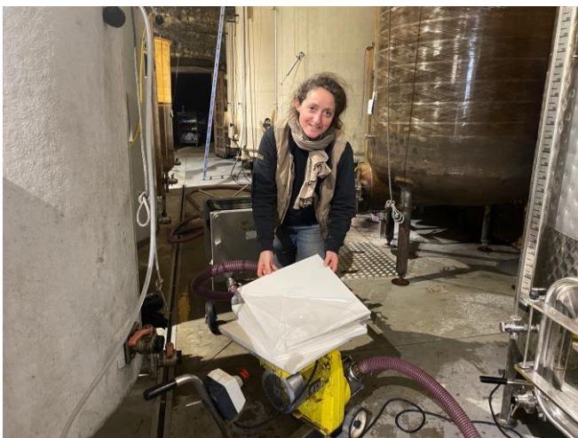
(写真①) ノエラ後ろのステンレスの箱がフィルター装置 (写真②) 裏表を確認しながら、粗目のフィルターを設置中
