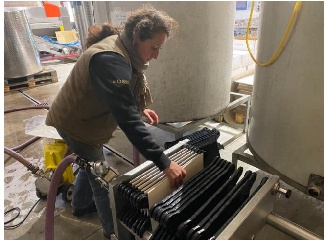
(写真①) ノエラ後ろのステンレスの箱がフィルター装置 (写真②) 裏表を確認しながら、粗目のフィルターを設置中
