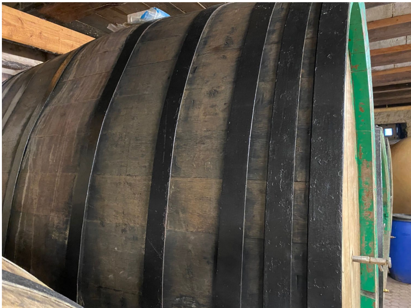
(写真③) 自作で修理し錆止めのために黒く塗装したフードルの箍
