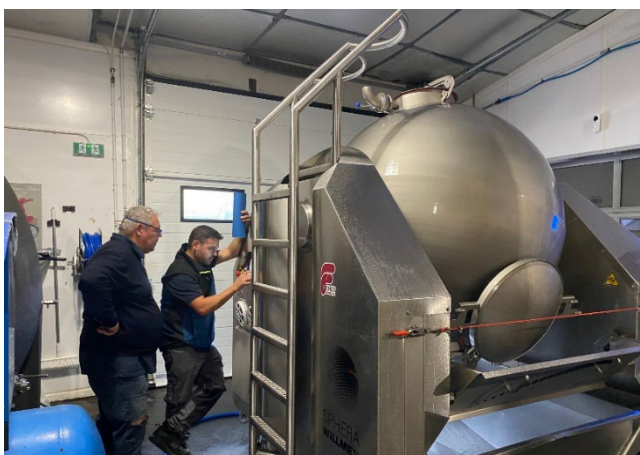
（写真③）世界に2つしかない球型空圧式圧搾機
