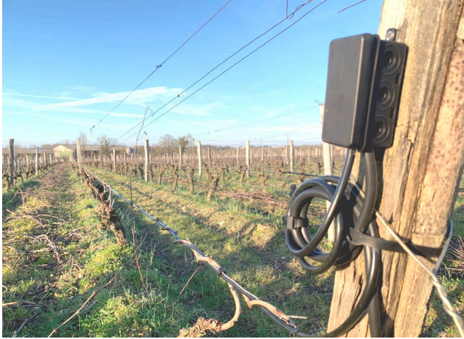
（写真②）このバッテリーでケーブルに電流を流し温める
