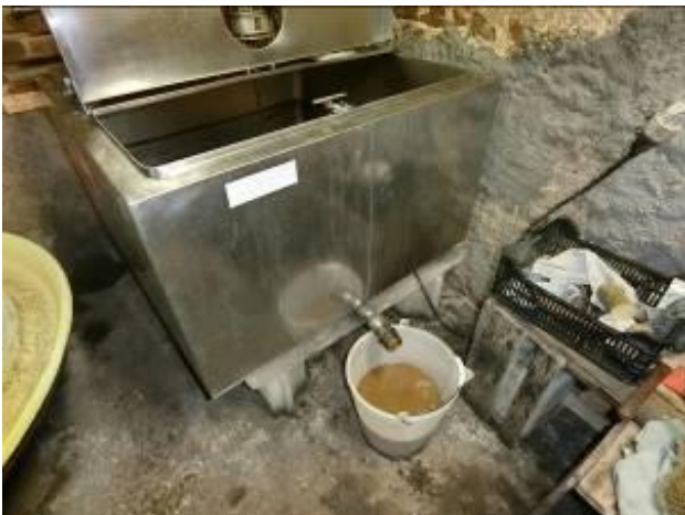
写真① 澱の清澄作業に使う冷却タンク
