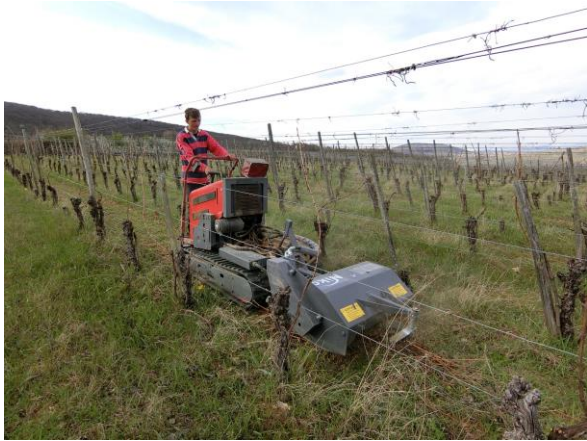
写真① 剪定した枝を粉碎機で細かく粉碎中
