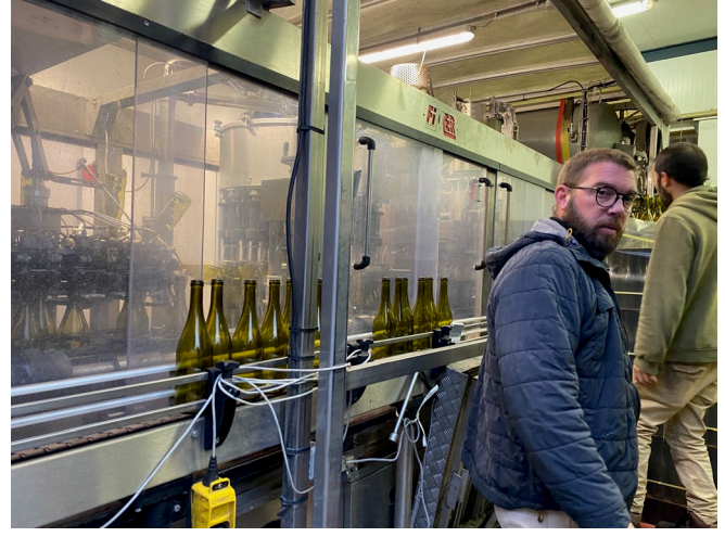
(写真①) ボトル業者に依頼し蔵を瓶詰めする風景 (写真②) 1時間当たり 3000 本瓶詰めできるマシン
