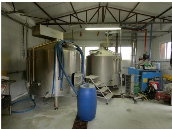
写真① ステンレス製の煮沸槽(手前)と糖化槽(奥)
